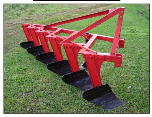
$\underline{\text{CARACTER\'ISTICAS:}}$ -DESENVOLVIDO COM ESTRUTURA EM CANTONEIRA COM REFORÇOS EM PONTOS DE MAIOR DESGASTE; -OPCIONAL: RODA PARA REGULAGEM DE PROFUNDIDADE;
